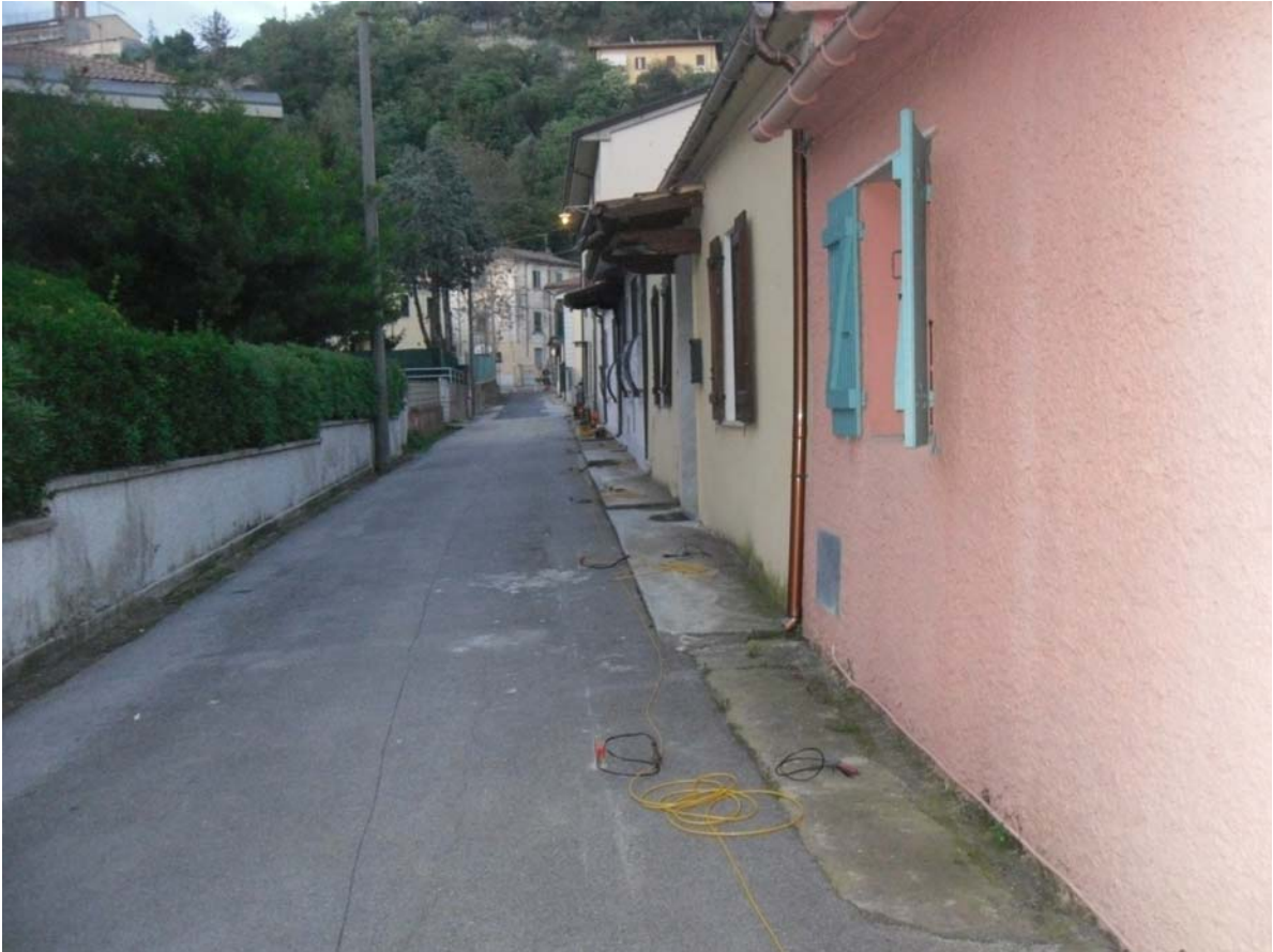
Foto n.2 Disposizione dei geofoni lungo lo stendimento.
